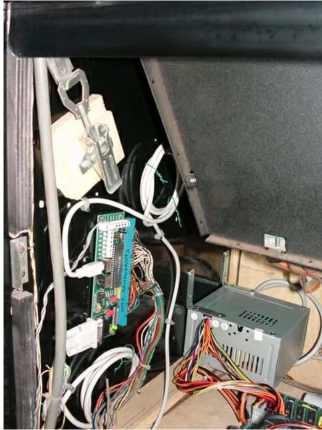
FIG. 14 – Carte J-Pac (à gauche), avec les câbles reliés au PC
